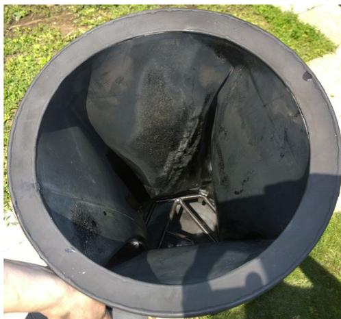
На данной фотографии видно смятие внутренней стенки нагревателя с разрывом сварочных швов высоким давлением воды вследствие нарушений правил подключения (подключение нагревателя напрямую к скважинному (дренажному) насосу без ограничителя давления, либо установка ограничителя давления существенно выше нагревателя, либо подача очень большого количества воды в ограничитель давления, либо кипение нагревателя).
