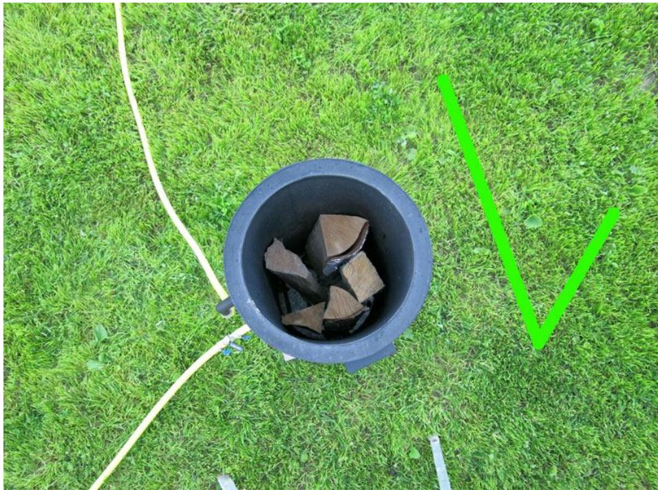
Не нужно набивать нагреватель дровами, от этого он будет работать плохо. Не нужно запикивать в нагреватель большие куски древесины, он сделан из тонкого металла и может сломаться.
