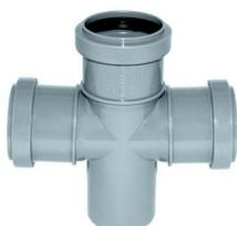
Расположите крестовину как показано на рисунке выше. Вставьте переходники слева и справа до упора (рекомендуется предварительно смочить резиновые прокладки крестовины водой). Вставьте заглушку снизу до упора. Вставьте двухметровую трубу в крестовину сверху (верх трубы остается открытым). Сборка ограничителя завершена.
