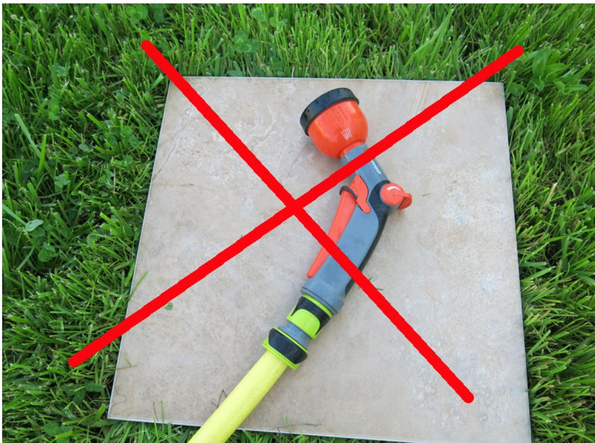
ЗАПРЕЩАЕТСЯ пережимать отводящий шланг - произойдет разрушение нагревателя высоким давлением.
