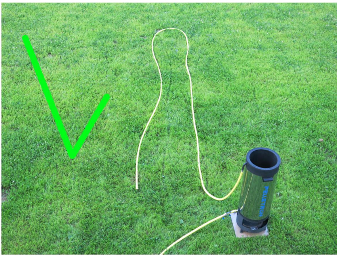
Лучше всего на отводе воды применять армированный спиралью шланг с гладкой внутренней поверхностью. Такой шланг всегда сохраняет круглое сечение, хорошо противостоит перегибам и сдавливаниям.
