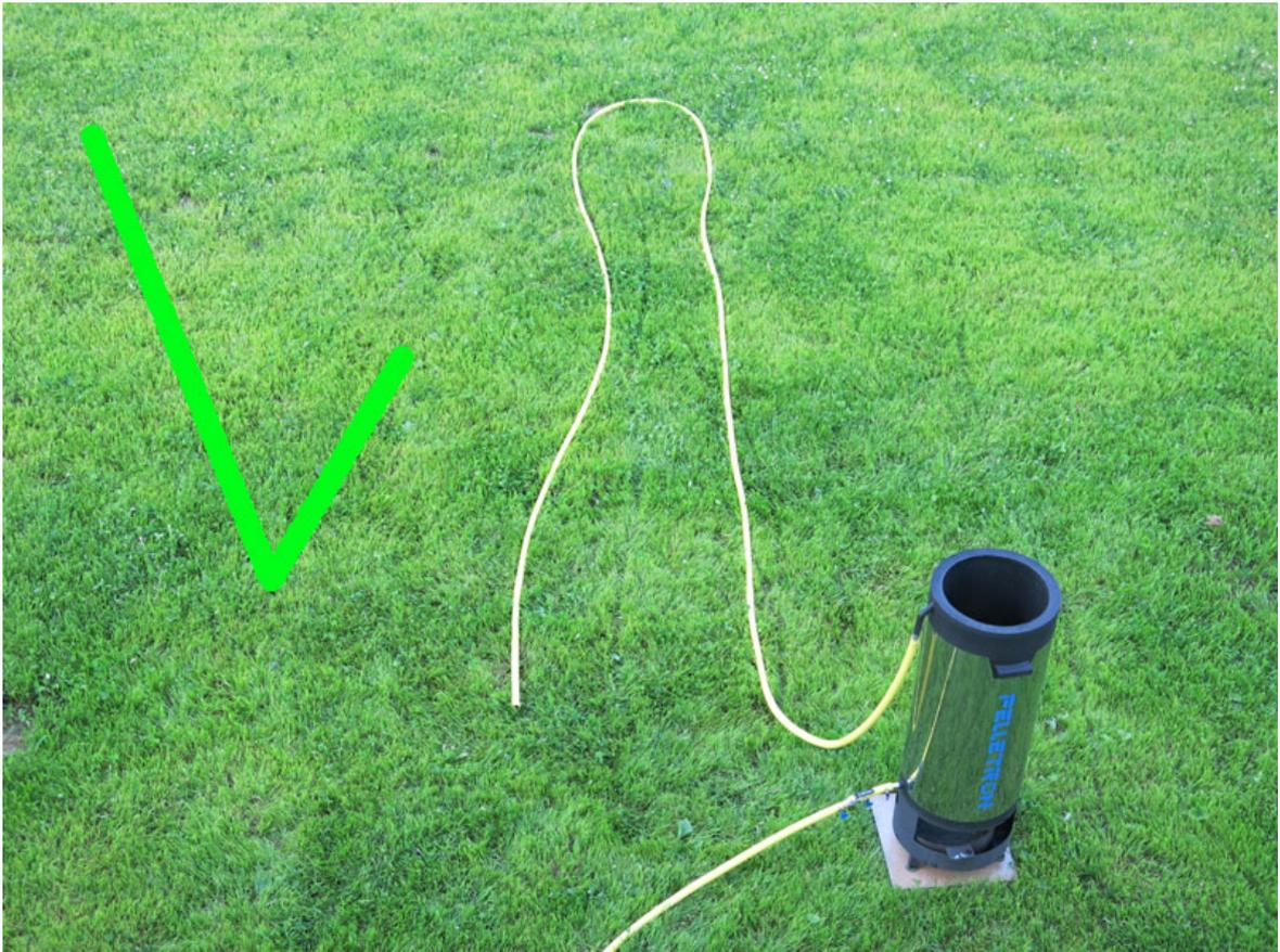
Лучше всего на отводе воды применять армированный спиралью шланг с гладкой внутренней поверхностью. Такой шланг всегда сохраняет круглое сечение, хорошо противостоит перегибам и сдавливаниям.
