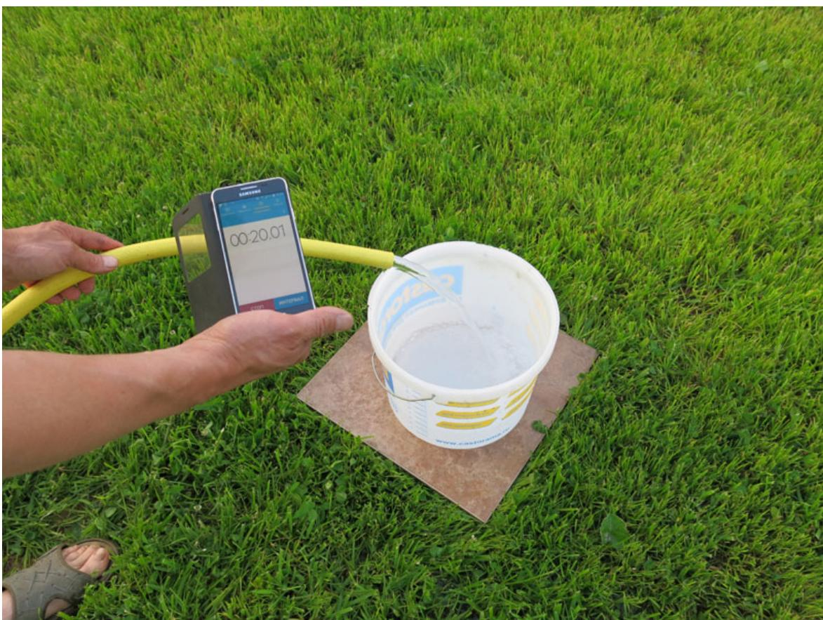
**ЗАПРЕЩАЕТСЯ** подавать воды больше 20 л в минуту - произойдет разрушение нагревателя высоким давлением. Нагреватель все равно не может нагреть больше воды, он просто сломается.
