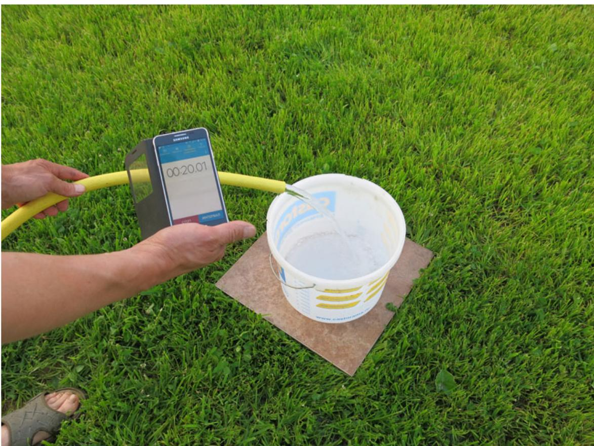
ЗАПРЕЩАЕТСЯ подавать воды больше 20 л в минуту - произойдет разрушение нагревателя высоким давлением. Нагреватель все равно не может нагреть больше воды, он просто сломается. Вот так НЕ НУЖНО делать:
