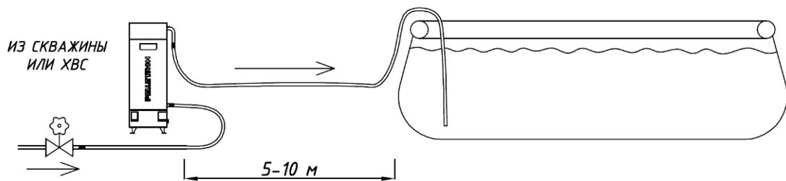
Схема установки нагревателя при подогреве полного бассейна в режиме циркуляции с использованием дренажного насоса.
